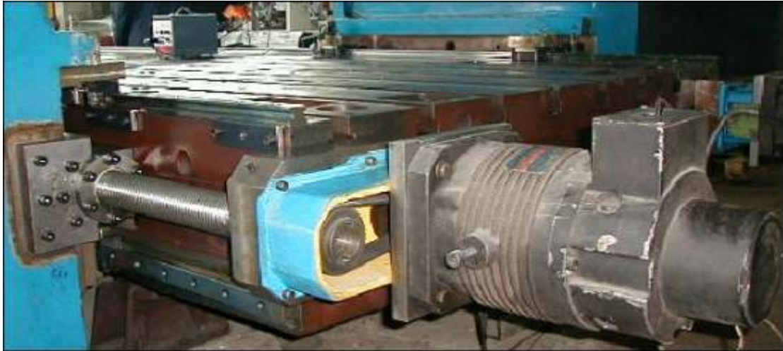
Fig.3 Servomotorul de antrenare al lanțului cinematic de avans/ poziționare și suportul de lagăr al șurubului de avans pe care au fost montate accelerometrele în ultimele variante de încercare
